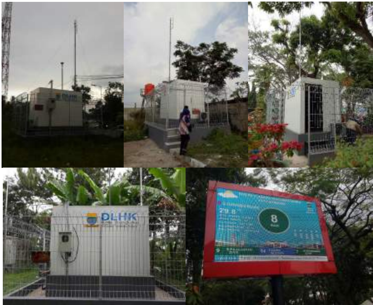
Gambar 3.1. Alat AQMS (Air Quality Monitoring System) Kota Bandung ditempatkan di lokasi Jalan Pajajaran, Dago, Ujungberung dan Gedebage, serta display di Taman Dewi Sartika, Balaikota Bandung
