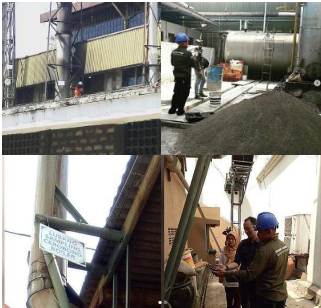
Gambar 3.12 Pengukuran kualitas udara emisi cerobong
